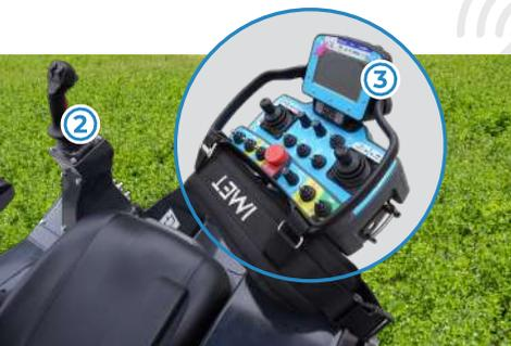
Posizione di guida con Tettuccio omologato ROPS/FOPS, sedile imbottito reclinabile e regolabile longitudinalmente. In modalità guida a bordo i controlli di traslazione e azionamento del sollevatore vengono trasferiti ad un joystick ergonomico proporzionale che permette un controllo preciso della macchina.
